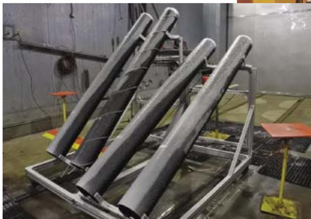
◀ Modèles de câbles de pont à haubans exposés à la pluie verglaçante dans l'installation d'essais climatiques du CNRC
