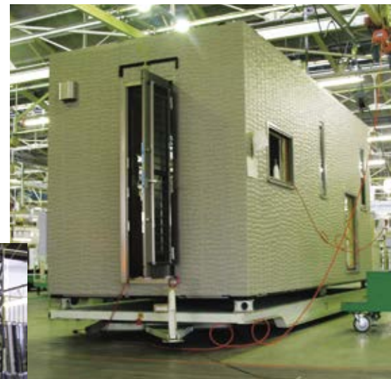
▲ Au Japon, des divisions de grandes entreprises comme Toyota Housing, Sekisui Chemical ou Misawa Homes construisent des bâtiments à l'aide de chaînes de montage semblables à celles de l'industrie automobile. Ici, une partie d'une chaîne de montage chez Toyota Housing. Photos : Roger-Bruno Richard
