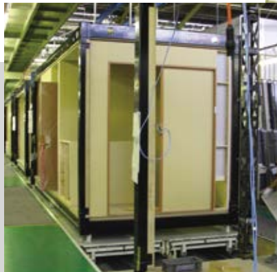
▲ Au Japon, des divisions de grandes entreprises comme Toyota Housing, Sekisui Chemical ou Misawa Homes construisent des bâtiments à l'aide de chaînes de montage semblables à celles de l'industrie automobile. Ici, une partie d'une chaîne de montage chez Toyota Housing. Photos : Roger-Bruno Richard
